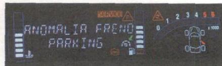
Quando aparece uma mensagem escrita no painel de instrumentos a dizer que há uma anomalia no travão de estacionamento é necessário levar o carro a uma oficina
